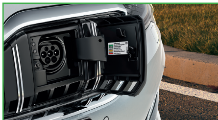
HYBRYDA TYPU PLUG-IN możliwość ładowania z zewnętrznego źródła energii
