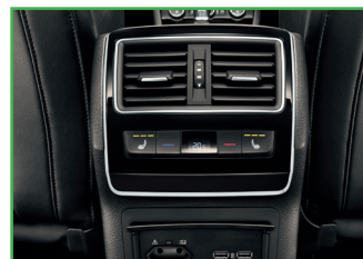
CLIMATRONIC automatyczna klimatyzacja trójstrefowa z regulacją elektroniczną
