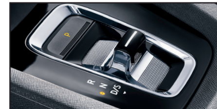
SHIFT-BY-WIRE Elektroniczne sterowanie skrzynią biegów DSG
