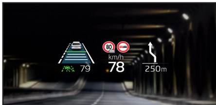
WYŚWIETLACZ HEAD-UP Podstawowe dane dostępne na szybie, w zasięgu wzroku kierowcy
