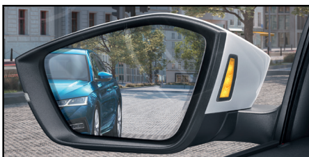
SIDE ASSIST Z EXIT WARNING Monitorowanie martwego pola i ostrzeganie przed wysiadaniem, gdy istnieje ryzyko kolizji z pojazdem z tyłu
